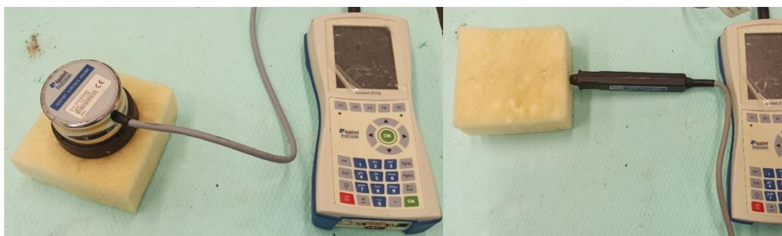
Figura 30 - Ensaio de condutibilidade térmica com sonda plana (esq.) e com sonda de agulha (dta.)
