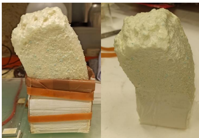
Figura 26 - Máscara 7 utilizando 20g de reagentes na forma cúbica de 8 cm de aresta
