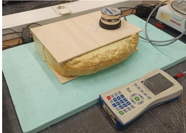
Figura 31 - Ensaio de condutividade térmica com sonda plana a painel sandwich
